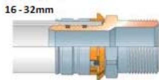
Figure 1 - Raccord à sertir métallique
